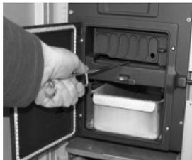
3. Der Sturzzugraum muss regelmäßig gereinigt werden. Dazu die Herdplatte abnehmen und Sturzzug nach oben herausziehen.
