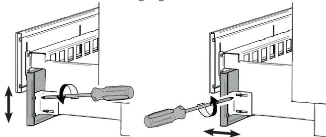
Befestigungsschrauben der seitlichen Sockelblende lösen, Blende nach unten beziehungsweise nach vorne/hinten verstellen und Befestigungsschrauben wieder festdrehen.
