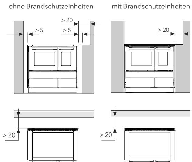
Bei Anbau an brennbare Materialien bzw. Einbau in eine Küchenzeile oder Anbau an einen E-Herd oder ein anderes Gerät ist eine Brandschutzeinheit vorgeschrieben. Maximale Höhe der angebauten Einrichtungsgegenstände entspricht hierbei der Herdhöhe. Einrichtungsgegenstände über Herdhöhe müssen
