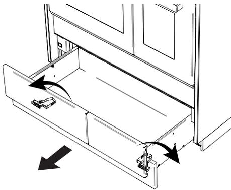
Zum Einsetzen die Lade auf die Schienen legen und bis zum Anschlag schließen.
