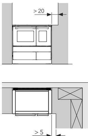
auf der Feuerraumseite mind. 20 cm entfernt sein. Auf der Rauchrohranschlusseite ist kein Sicherheitsabstand erforderlich. Küchenanbauten vor dem Herd müssen mindestens 5 cm von der Geräteaußenkante entfernt sein.
