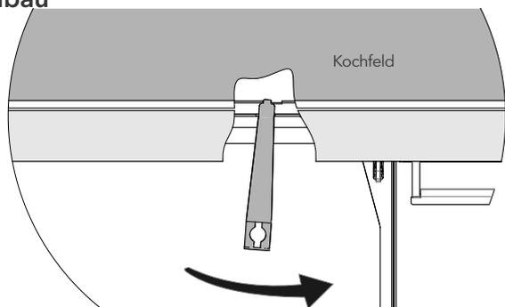
Das Kochfeld hinten in die beiden Halte-Rollen einhängen und vorne absenken. Die Backrohtür öffnen und den Bedienelement in die Öffnung über dem Backrohr einführen. Das Kochfeld leicht nach unten drücken. Anschließend den Bedienelement nach links schwenken und das Kochfeld fixieren.
