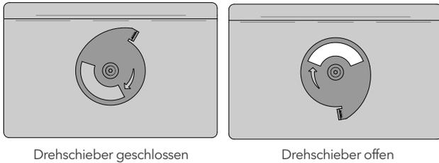
**HINWEIS: Der Drehschieber ist selbstständig, verlässlich und ehestmöglich (wenn das Holz angebrannt ist) vom Betreiber wieder zu schließen. Er dient nur als Noteinrichtung bei ungünstigen Druck- oder baulichen Bedingungen.**
