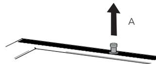
Gleichzeitig öffnet sich die Anheizklappe auf der Backrohrseite, dadurch wird ein direkter Weg vom Feuerraum in den Kamin freigegeben. Die Rauchgase müssen somit nicht den „langen“ Weg um das Backrohr nehmen, sondern gelangen - noch heiß - in den Kamin wodurch sehr rasch ein Kaminzug aufgebaut wird.
