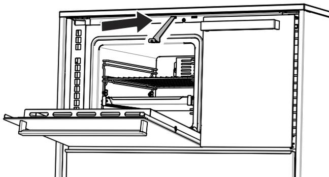
entriegelt. Anschließend das Kochfeld mit dem Bedienelement nach oben drücken und abnehmen.
