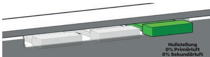
Die Primärluftzufuhr ist für das Anheizen notwendig. Die Anheizstellung darf nur für das Anheizen verwendet werden.
