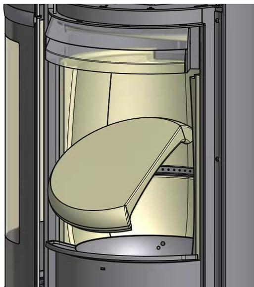
Obere Rauchumlenkplatte heben und den Stift entfernen. Die Umlenplatte durch die Brennkammer vorsichtig herausnehmen.
