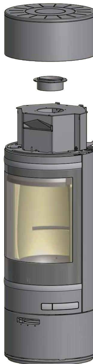
Dichtung auf dem Stutzen montieren.
