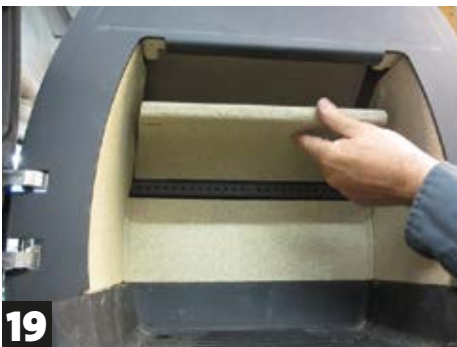
16 Platte hochschieben, damit sie vorne auf der Frontplatte liegt.
