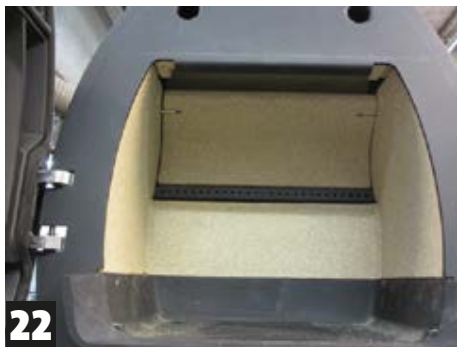
19 Die Platte auf der Schiene mit den Luftlöchern stützen lassen
