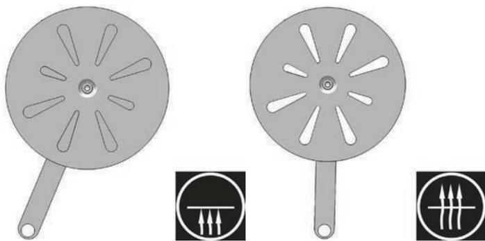
Der Rüttelrost sollte grundsätzlich offen bleiben! Die Regelung der Luftzufuhr erfolgt über den Regler für die Luftzufuhr.
